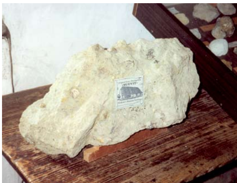
Suevit, das zu ca. 98 % aus kristallinem Grundgebirge mit Schmelzanteilen und zu ca. 2 % aus Sedimenteinschlüssen besteht.
